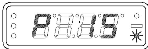
Figure 6.13 heater in «ignition mode»
