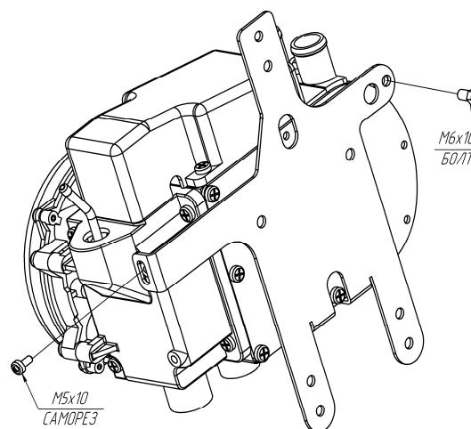
Рис. 7.1а – Схема крепления кронштейна.
