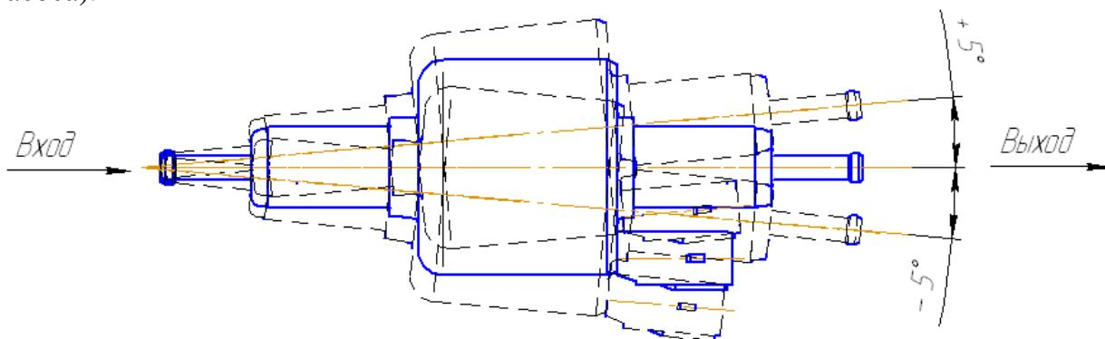
Рис. 7.8 Допустимое монтажное положение бензинового топливного насоса
