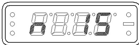
Рис .6.19 – Индикатор при работе помпы
