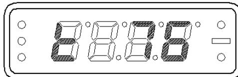
Рис. 6.8 – Температура теплоносителя.
