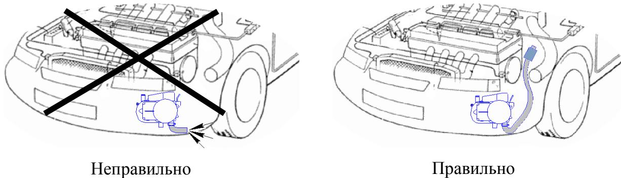
Рис.7.3а – Монтаж подогревателя за бампером.
