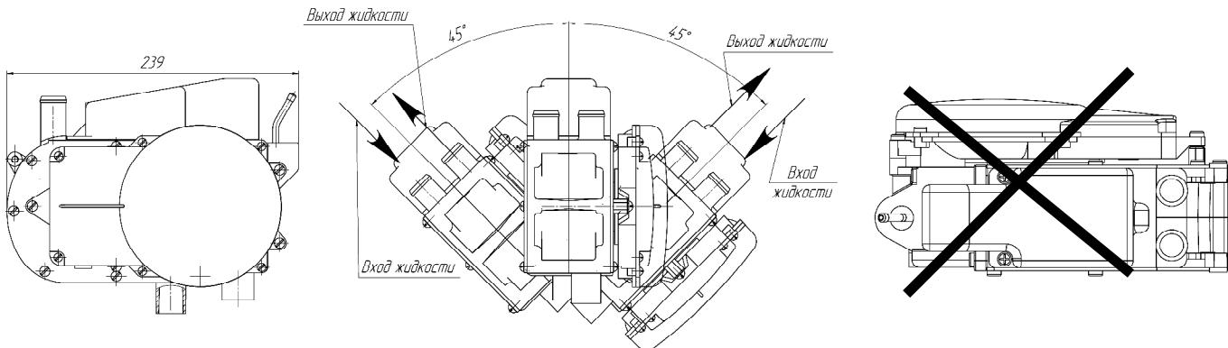
Рис. 7.2- Допустимые рабочие положения нагревателя
