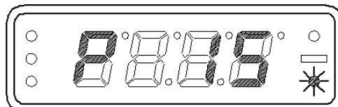
Рис. 6.13 – Индикатор при работе подогревателя в режиме розжига.
