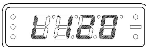
Рис.6.12 - Установка времени непрерывной работы подогревателя
